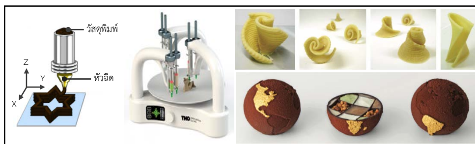
ภาพที่ ๒ การพิมพ์แบบอัดรีดขึ้นรูปและตัวอย่างอาหารที่พิมพ์ได้ (ที่มา : Noort et al., 2017; Pitayachaval et al., 2018)
