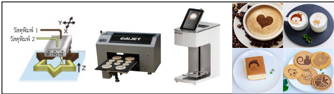
ภาพที่ ๓ การพิมพ์แบบพ่นหมึกและตัวอย่างอาหารที่พิมพ์ได้ (ที่มา : Pallottino et al., 2016; Pitayachaval et al., 2018)
