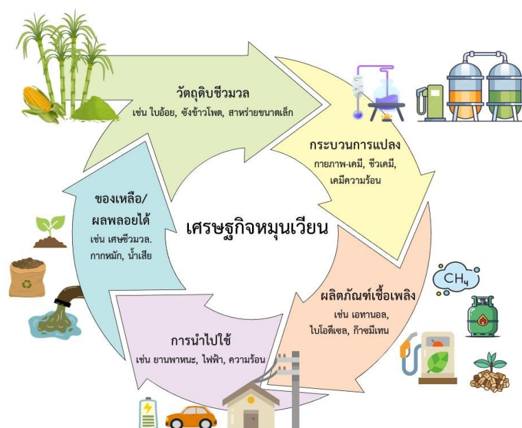
ภาพที่ ๑ วงจรการผลิตเชื้อเพลิงจากของเสียตามแนวคิดเศรษฐกิจหมุนเวียน
