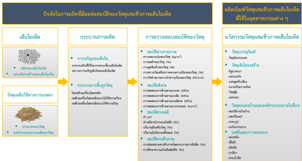
ภาพที่ ๒ กระบวนการผลิตและปัจจัยที่มีผลต่อสมบัติของวัสดุผสมชีวภาพเส้นใยเห็ด (Aiduang et al., 2022a)
