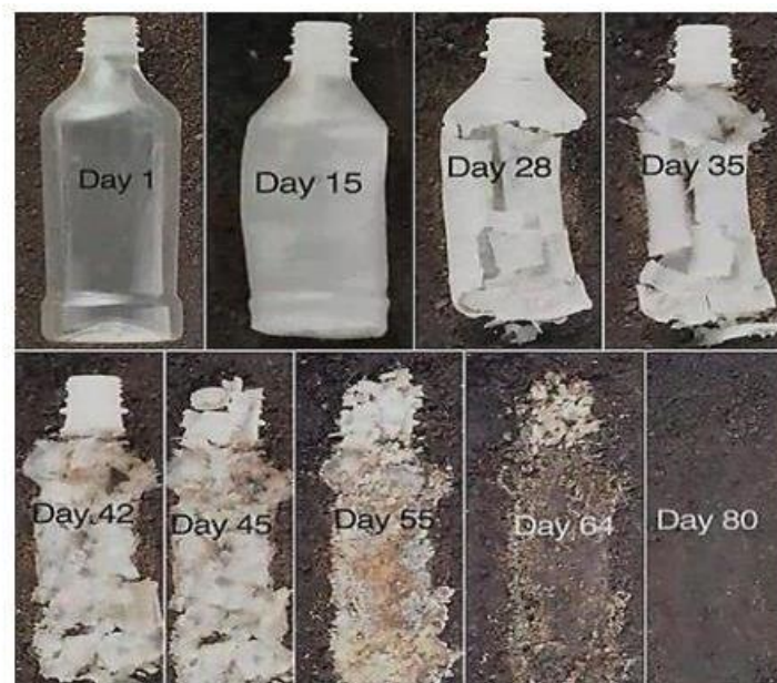
ภาพที่ ๒ การย่อยสลายทางชีวภาพของขวดพลาสติกสังเคราะห์จากพอลิเมอร์ฐานชีวภาพชนิด PHA โดยวิธีการบ่มในดินโคลนเป็นระยะเวลา ๘๐ วัน (ที่มา: Sudesh et al., 2000)
