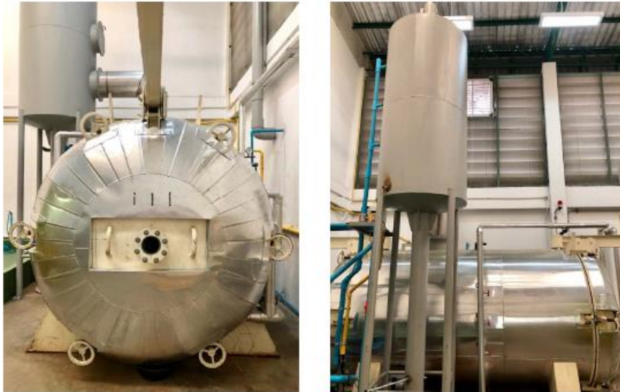
ภาพที่ ๒ เครื่องอบแห้งไอน้ำร้อนยวดยิ่งที่สภาวะความดันต่ำระดับอุตสาหกรรม (ที่มา: บริษัท เนเชอรัล โปรดิวซ์เชส จำกัด)
