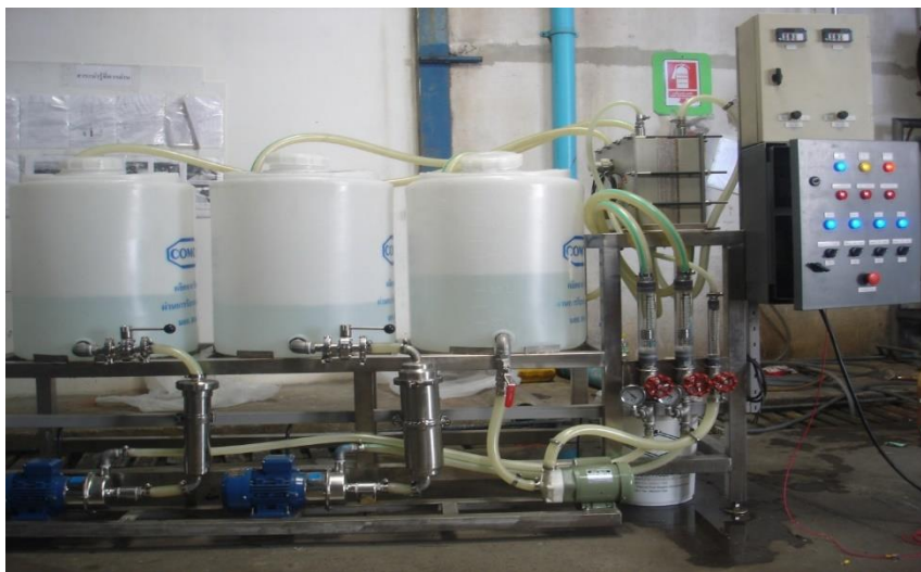
ภาพที่ ๓ เครื่องแยกสารผ่านเยื่อด้วยไฟฟ้าระดับอุตสาหกรรม (ที่มา: Jundee et al., 2012)
